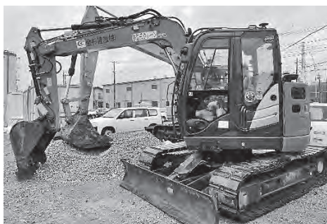
後付けICTシステムを実装した建設機械
