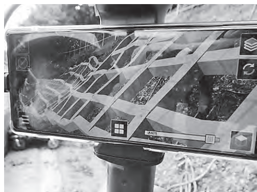
図-8 MR技術活用による芯出し作業
