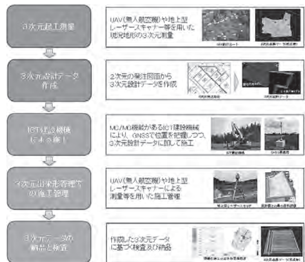
図-3 情報化施工のプロセス
