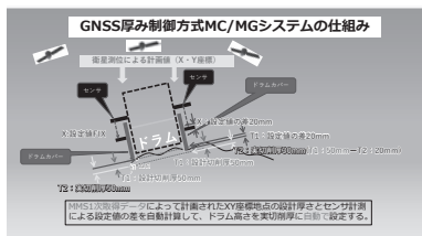
図-4 3D MC/MGシステムの仕組み
