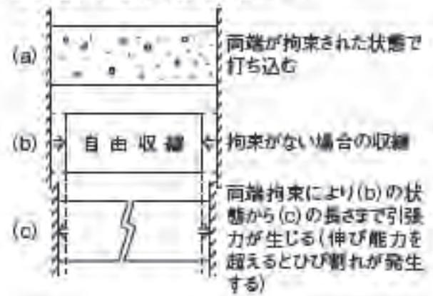
図1 初期ひび割れの発生メカニズム<sup>1)</sup>
