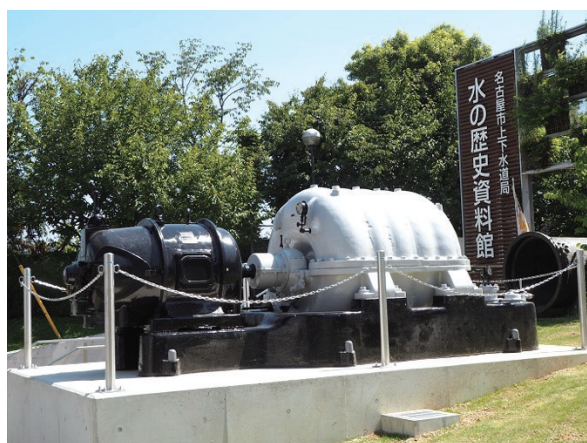
(写真12) 日本初の活性汚泥法を支えたブロワ (旧堀留下水処理場)
