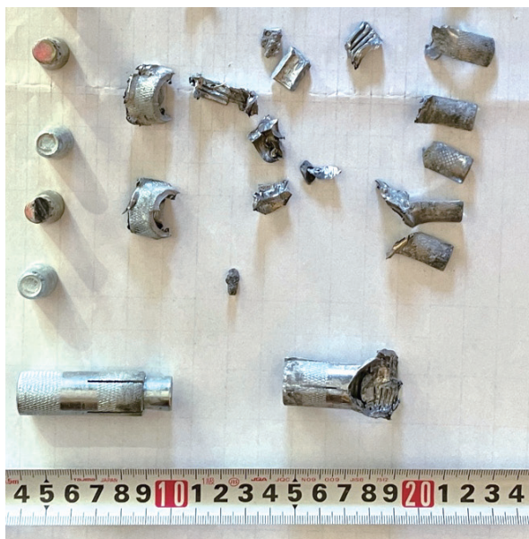
写真-3 切削後のアンカーボルト
