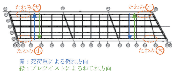
図-9 桁の倒れとねじれ方向
