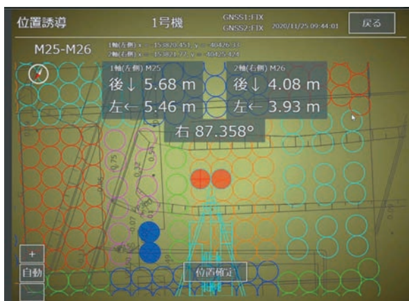
図 3-5 CDM 施工管理システム【CDM-Navigate】による杭芯誘導表示例
