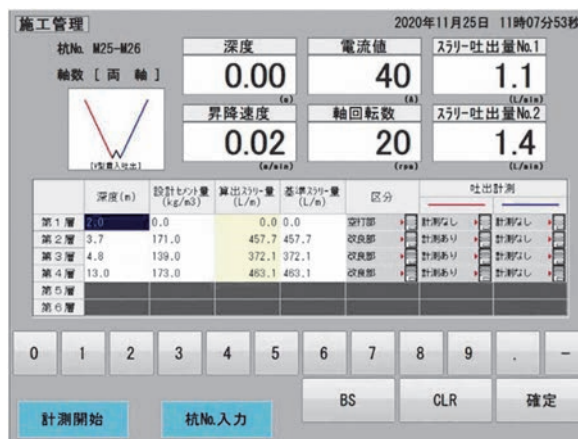
図 3-4 CDM 施工管理システム【CDM-Navigate】による施工情報画面
