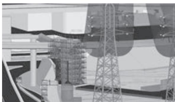
躯体とクレーンが干渉し、大型ブロック積みの作業ができないことが判明。柱の一部と梁施工前に大型ブロック積みの作業を行うことで、躯体とクレーンの干渉が回避できた。
