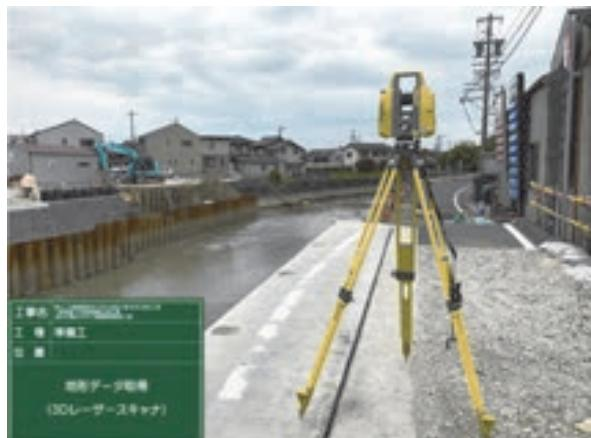
写真-1 3D レーザースキャナ点群測量
