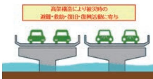
図-7 津波による被害を回避（高架構造）
