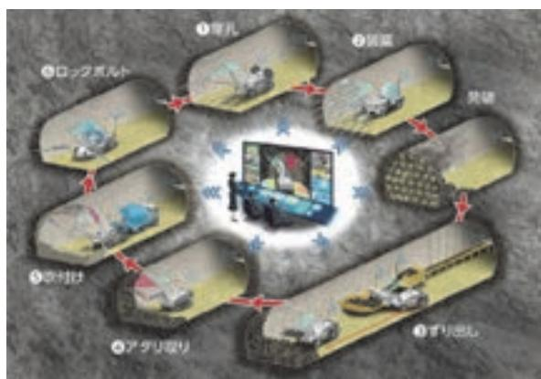
図1 「A<sup>4</sup>CSEL for Tunnel」のコンセプト
