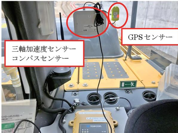
写真-2 車載センサー設置状況
