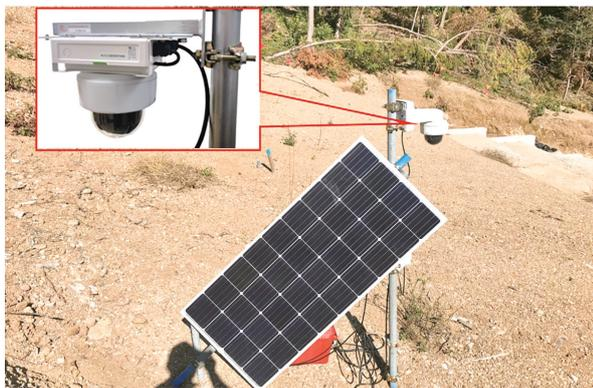
写真-1 クラウド型監視カメラ設置状況
