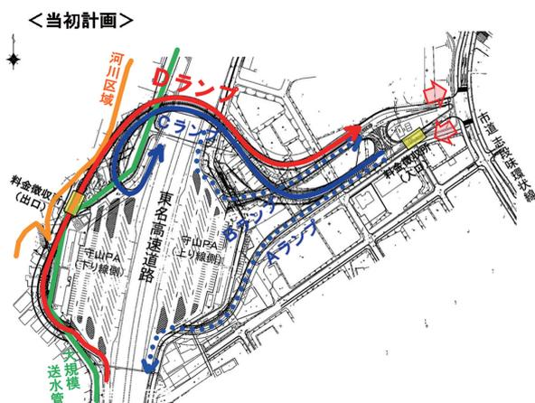
図-3 守山スマートICの当初の計画概要図
