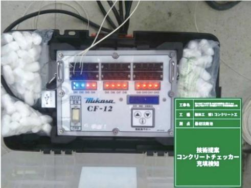
※コンクリートに埋め込んだセンサーにより、充填度が瞬時に識別可能
