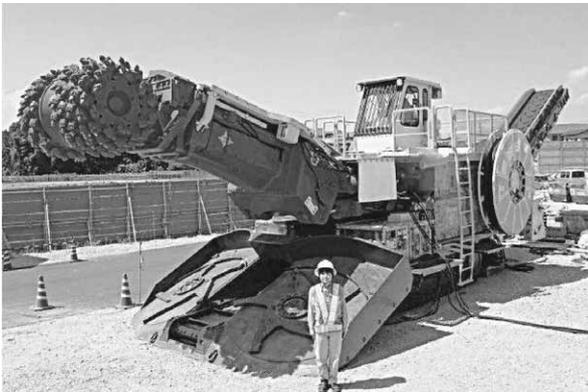
写真-4 横軸型ロードヘッダ
