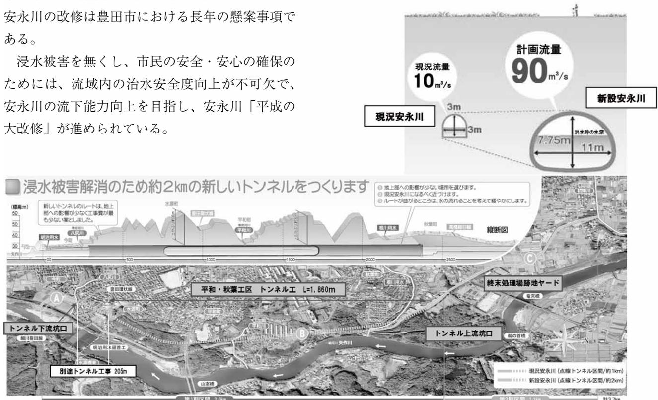
図-1 安永川トンネル縦断面図・平面図・断面図
